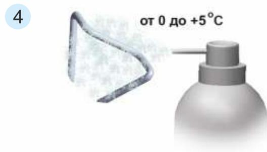
Скобу охлаждают до температуры от  $0^\circ\text{C}$  до плюс  $5^\circ\text{C}$  (4).
